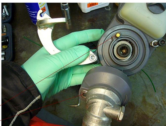
Ora inseriremo il **perno guida** sul foro della coppia conica ed il millerighe sul potatore
